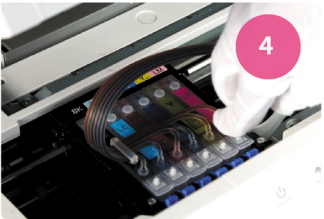
Установка СНПЧ. Рис. 4
